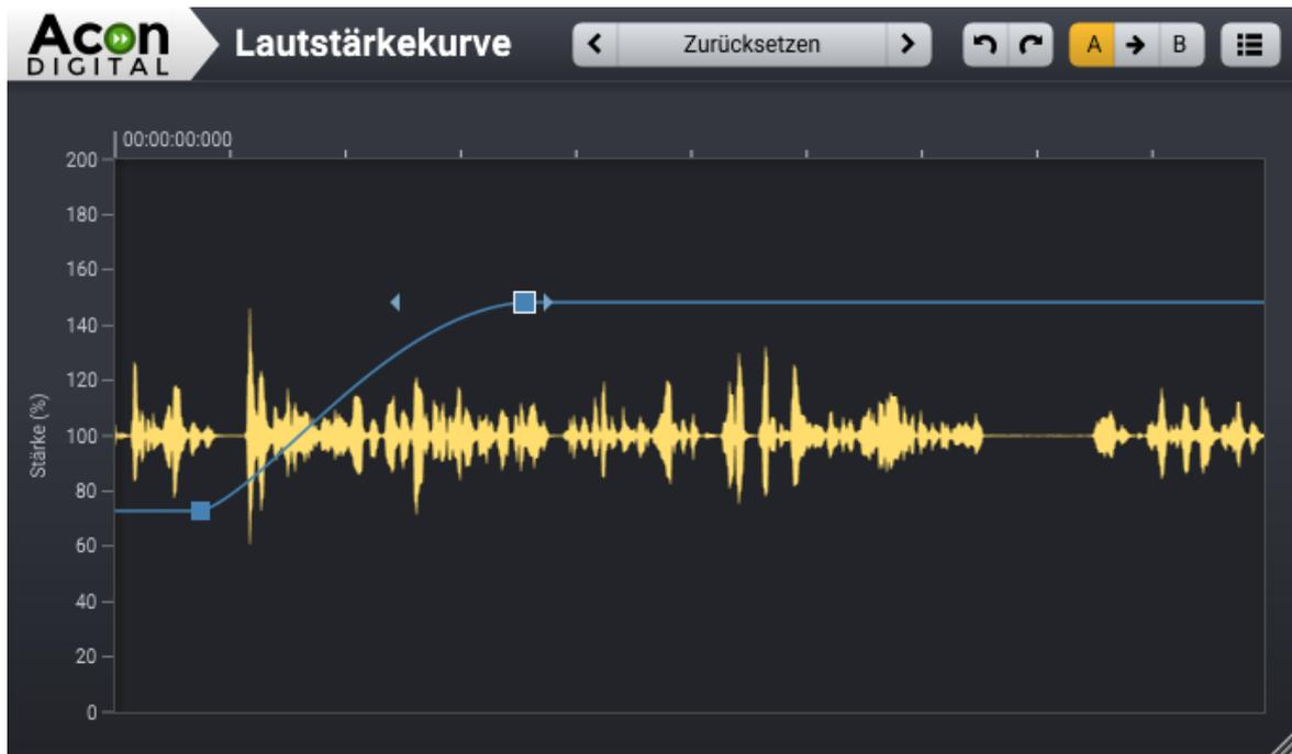
*Die Lautstärkekurve wird als blaue Kurve dargestellt. Beachten Sie den fokussierten Kurvenpunkt (weißer Rahmen), die beiden pfeilförmigen Ziehpunkte auf beiden Seiten des Punkts und die gerade Kurvenlinie hinter dem fokussierten Kurvenpunkt.*
