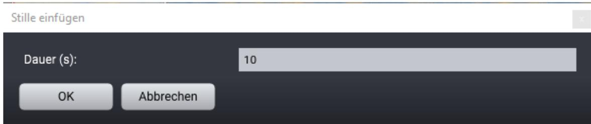
Das Stille Einfügen Werkzeug erlaubt das Einfügen von Stille an der Cursorposition.
