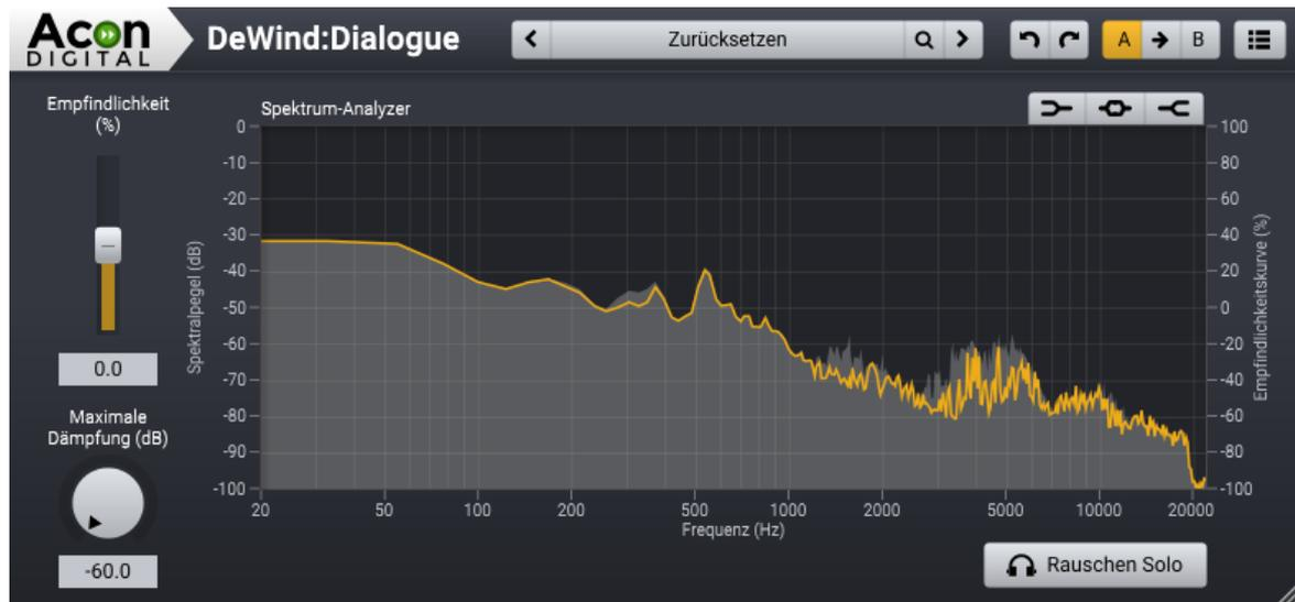
*DeWind:Dialogue vermindert automatisch Windgeräusche in Sprachaufnahmen. Der Spektrumanalyser stellt das Eingangssignal (ausgefüllte graue Kurve) und das entfernte Signal (gelbe Kurve) dar.*
