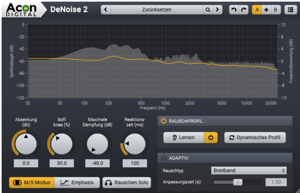
Die Benutzeroberfläche von DeNoise 2. Die Kurve zeigt das aktuelle Rauschprofil sowie eine Spektralanalyse des Eingangssignals.
