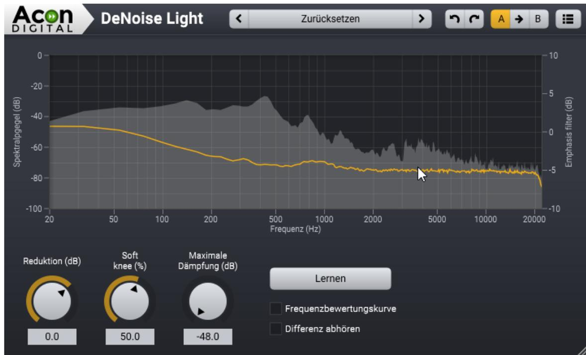
Die Benutzeroberfläche von *DeNoise Light*. Die Kurve zeigt das aktuelle Rauschprofil sowie eine Spektralanalyse des Eingangssignals.
