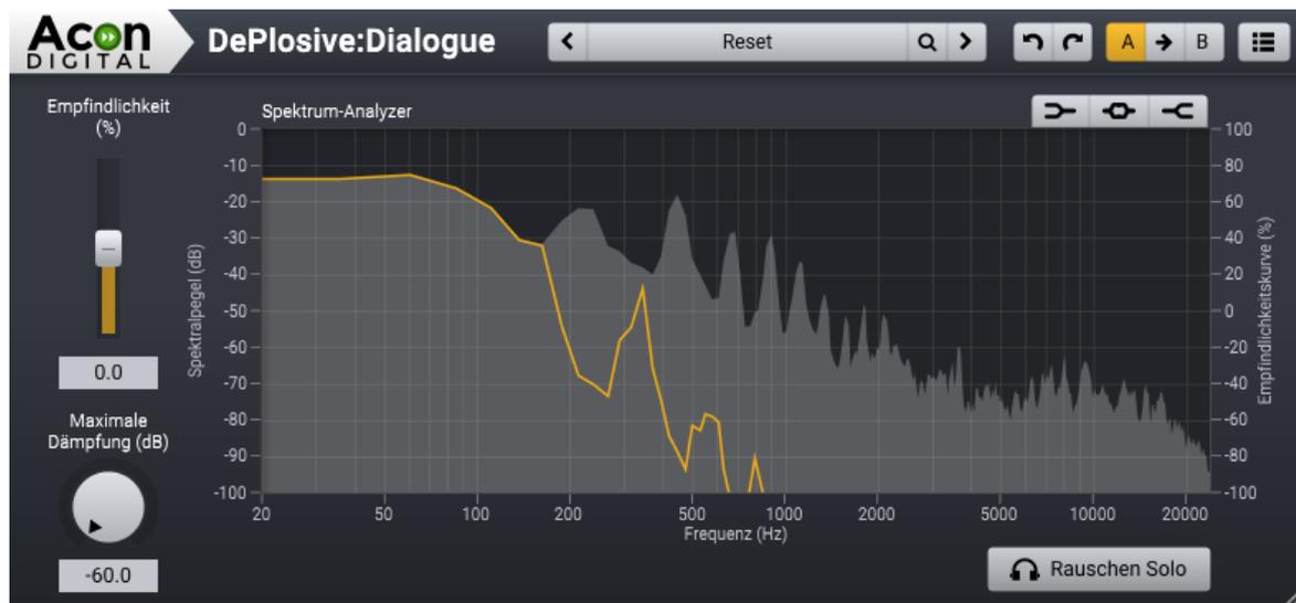
*DePlosive:Dialogue reduziert automatisch Plosive, Pops und tieffrequente Störungen. Der Spektrumanalyzer stellt das Eingangssignal (ausgefüllte graue Kurve) und das entfernte Signal (gelbe Kurve) dar.*
