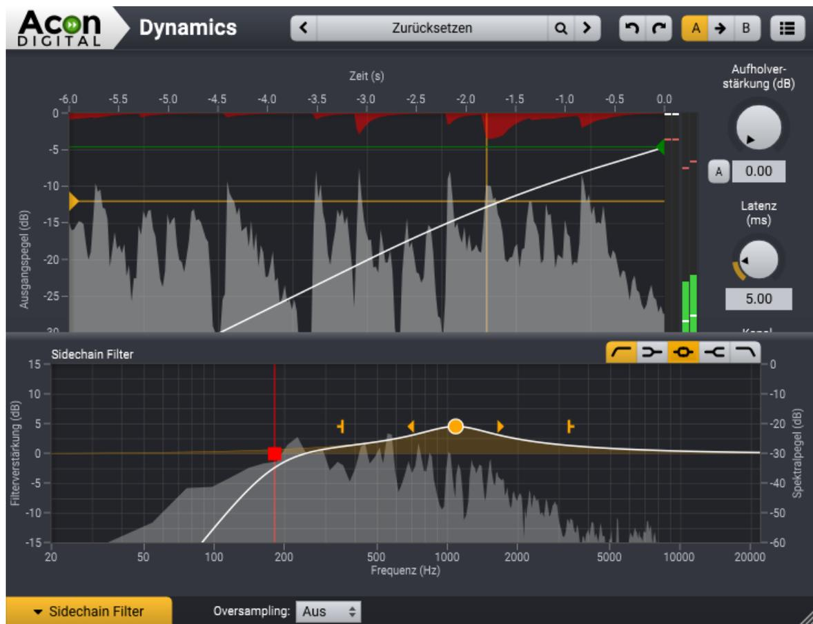
*Der Side Chain Filter in Dynamics ermöglicht die Filterung des Side Chain Signals in gleicher Weise wie ein Equalizer arbeitet.*
